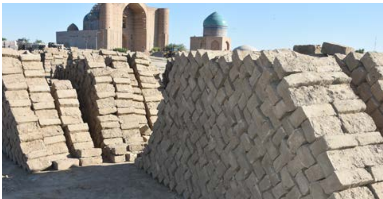
Кептірілген кірпіштерді жинақтау Складирование высушенного кирпича Storage of dried bricks
